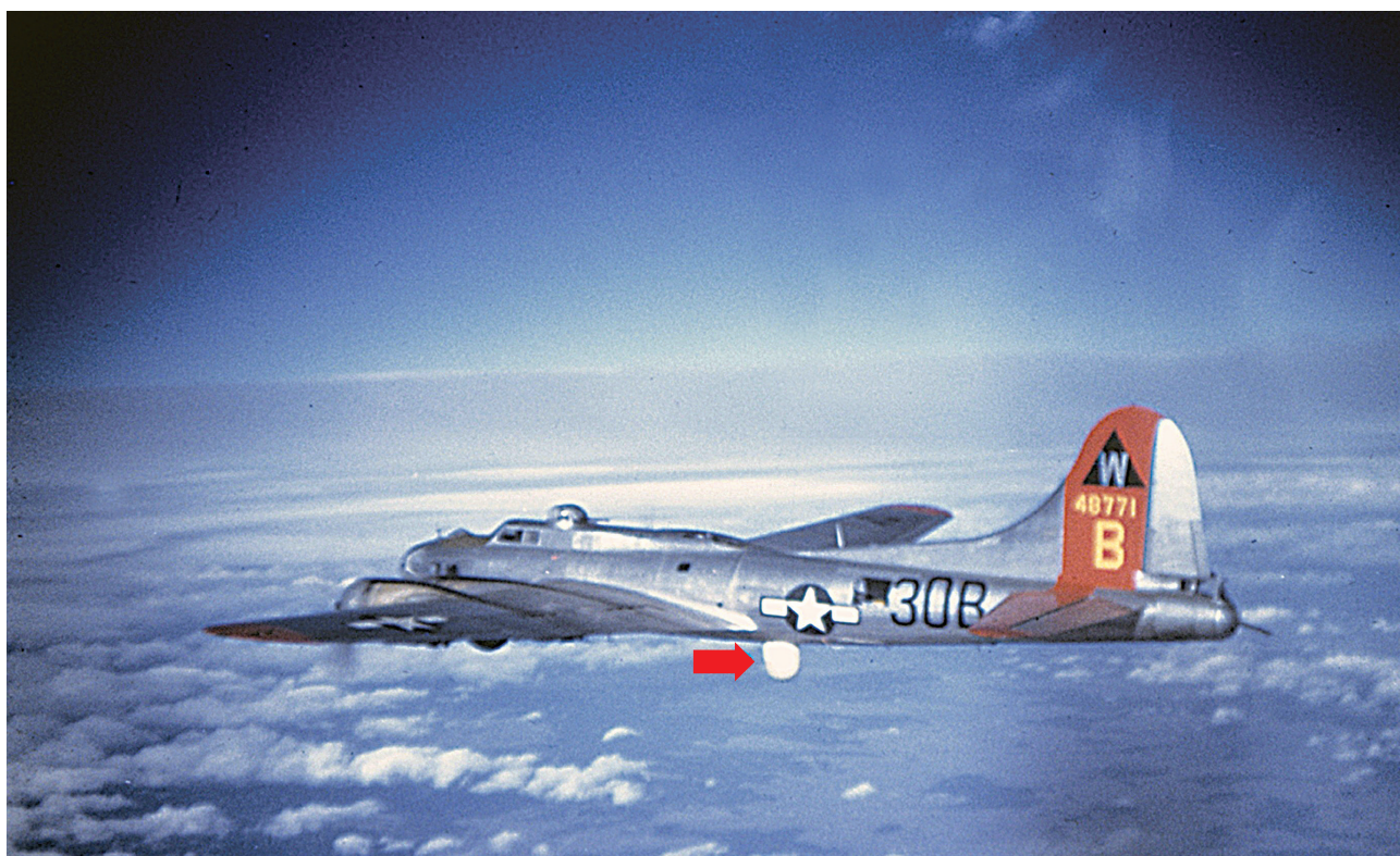
Vedoucí letoun 603. bombardovací perutě (ovšem ze stavu 601. perutě) 398. bombardovací skupiny (sér. číslo 44-8771, kódové označení 30-B) s charakteristickou kopulí radaru pod trupem místo spodní střelecké věže. Jde asi o nejznámější fotografii z mise 14. února 1945, jejímž autorem je 1st Lt. Robert M. Welty, druhý pilot letounu z osádky letounu se sér. číslem 43-38951.
