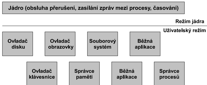
Obrázek 2.1: Schéma operačního systému založeného na mikrojádrě
