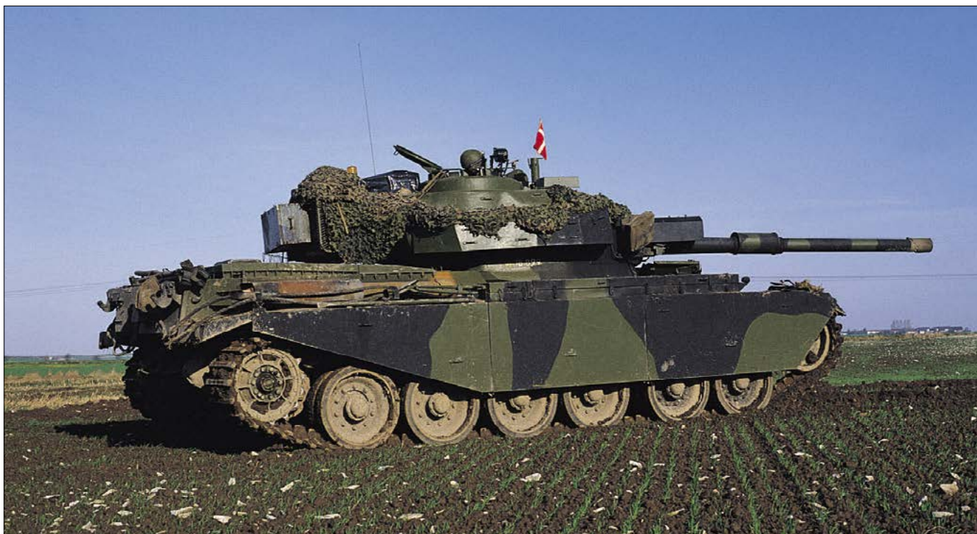
Britský tank Centurion v evropském kamuflážním schématu čeká během cvičení na rozkazy. Pověšimněte si pancéřových desek chránících pásy a kola proti střelám a minám.
