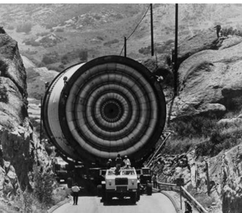
Výstavba testovacích stavů v Marshallově kosmickém středisku (Alabama). Na snímku zařízení 4670 alias S-IC Test Stand. Na něm pak 16. května 1965 došlo k prvnímu zážehu svazku pěti motorů F-1.
