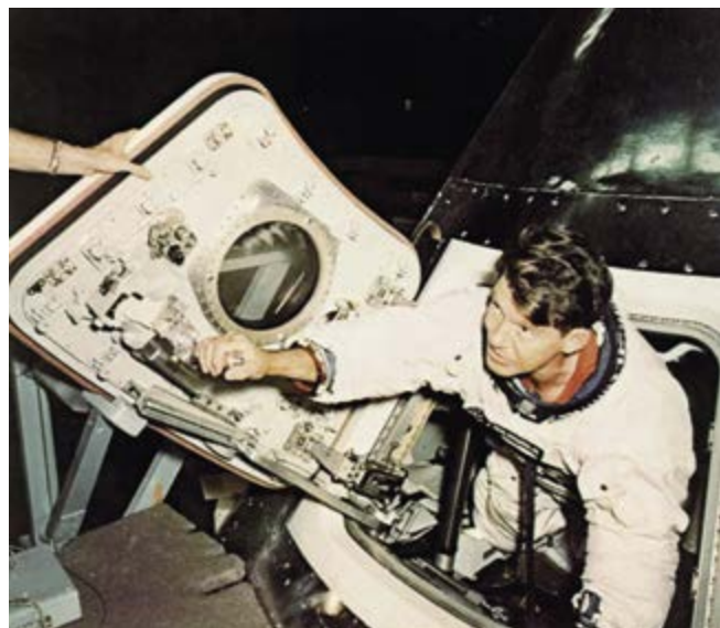
Srovnání první generace vstupního průletu lodi Apollo, který měl dveře otevírané dovnitř i ven, s druhou generací s jednoduchými dveřmi (jak demonstruje astronaut Walter Schirra).
