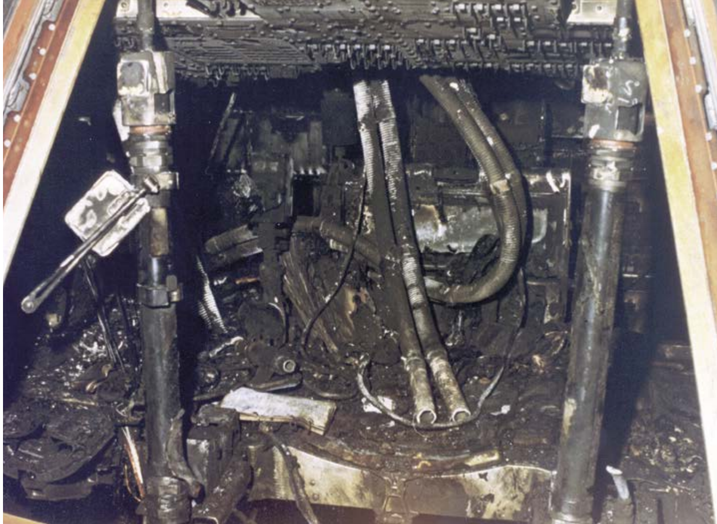
Detailní pohled do kabiny Apollo po tragickém požáru.
