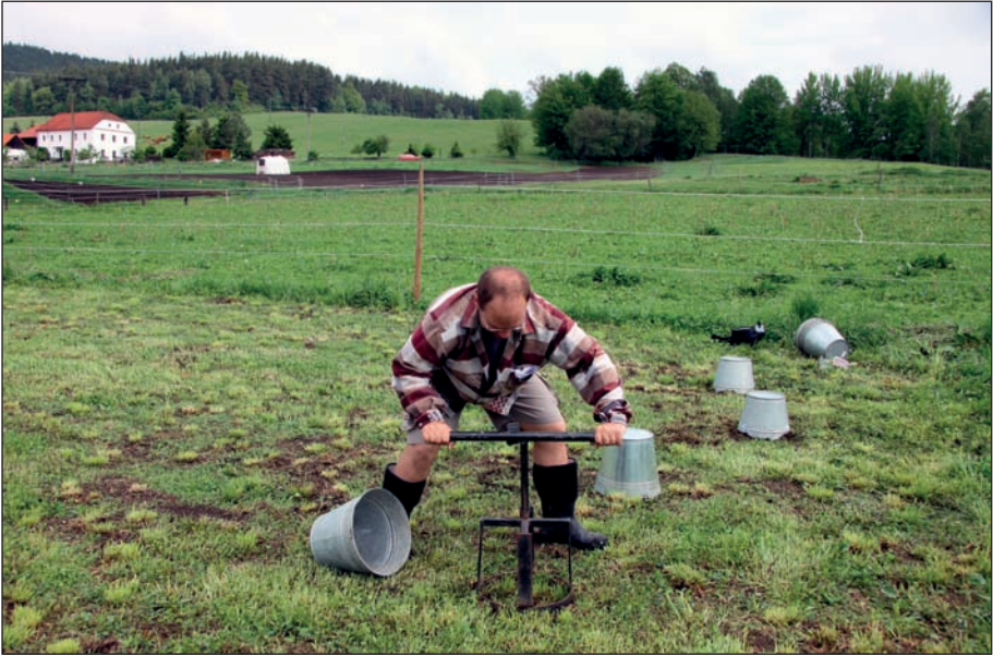
Obr. 3.2 Fyzicky namáhavá práce s půdním vrtákem při usazování komor do půdy. Stejným způsobem se mohou dostatečně dlouho před měřením usadit do půdy spodní části komor, na něž se pouze na dobu měření nasazuje svrchní část komory (foto Miloslav Šimek)
