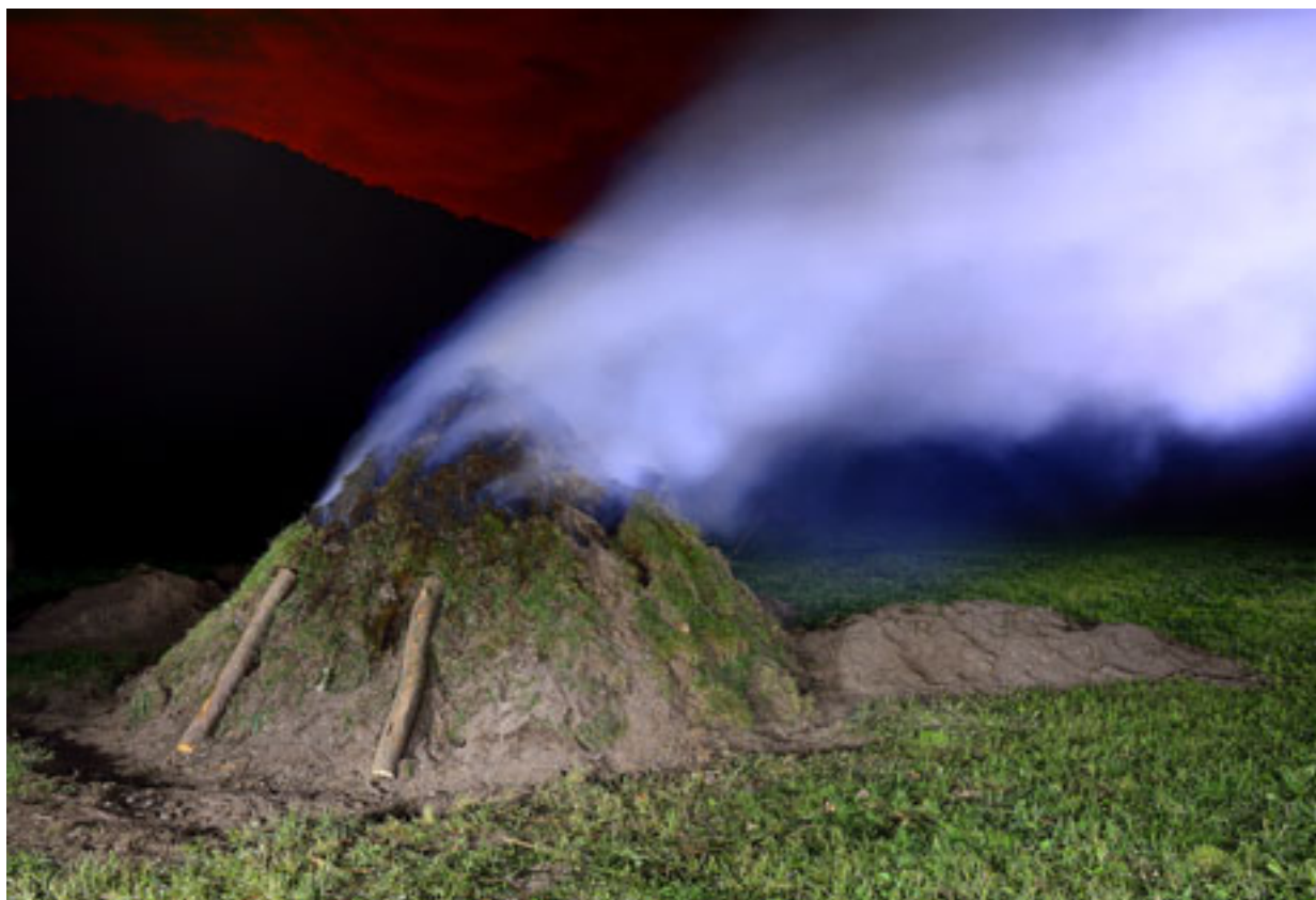
Klasickou výrobu dřevěného uhlí v milíři jsme mohli na Křivoklátsku vidět dokonce i v době přípravy tohoto textu. Milan Cyrus vypálil menší milíř v roce 2015 v Nižboru během oslav 750 let od první zmínky o obci. Jako zajímavost zařazujeme noční fotografii, na ní je nejlépe vidět, jak milíř majestátně dýmá a prohořívá postupně shora dolů. (MM)
