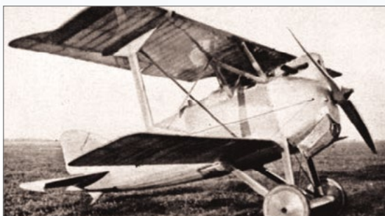
↑ Aero Ae-04 s novým typem chladiče a odhazovatelnou palivovou nádrží pod trupem
