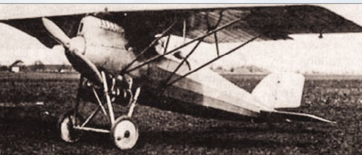
↑ Letov Š-3 s chladiči Lamblin na podvozkových vzpěrách
