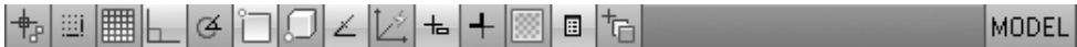
Obrázek 4.7 Tlačítka pro zapínání a vypínání kreslicích pomůcek na stavovém řádku AutoCADu 2011 – zobrazení formou ikon
