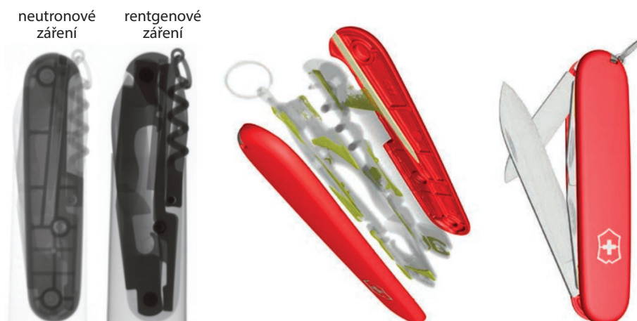
Obrázek 127 Transmisní radiografie (vlevo) a tomogram (vpravo) švýcarského armádního nože. Na rentgenovém obraze vynikají kovové části, zatímco plastové části jsou téměř průhledné. Neutronový obraz naopak zvýrazňuje plastové části a ochrannou olejovou vrstvu; podle [326]
