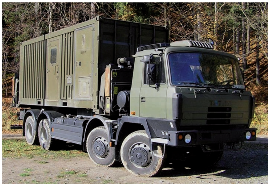
Obrázek 124 Mobilní laboratoř PPCHL-AL-2/R na podvozku Tatra 815 [323]
