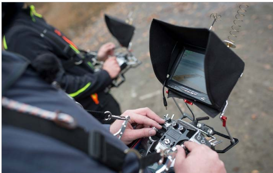
Obrázek 5.4 Pilot a operátor, každý se svým dálkovým ovládáním, včetně monitoru pro řízení natáčení v reálném čase z kamery pro operátora a monitoru pro pilota, který v něm může sledovat pohled z kamery na přední straně dronu
