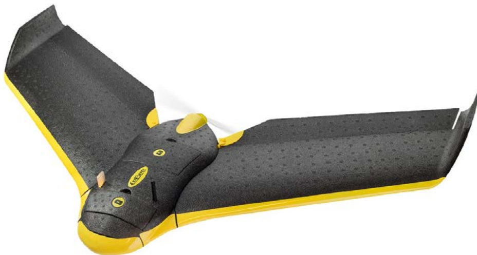
Obrázek 3.2 Bezpilotní mapovací letoun SenseFly eBee
