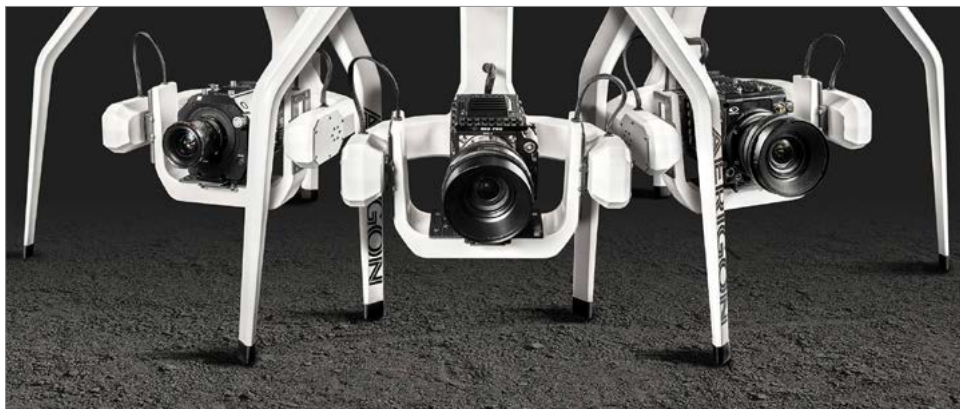
Obrázek 5.6: Kamerové závěsy (gimbaly) pod dronem s filmovými kamerami
