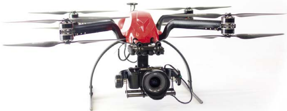
Obrázek 3.8 Oktokoptéra Scarabot X8 s protiběžnými motory pouze na 4 ramenech
