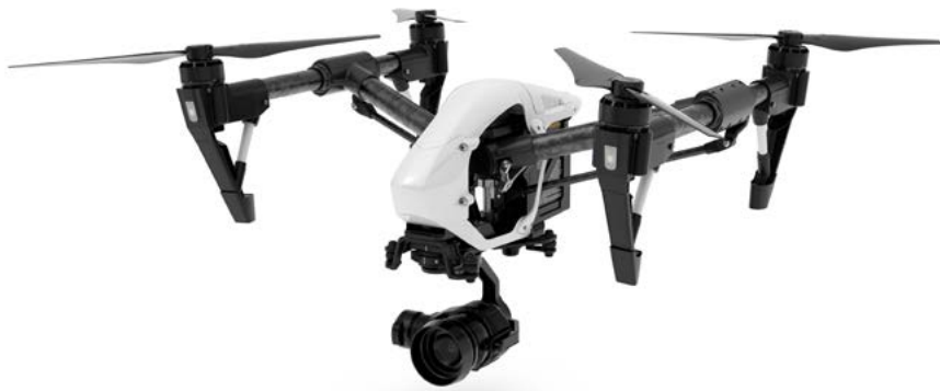
Obrázek 3.4 Kvadrokoptéra DJI Inspire určená spíše pro pokročilé uživatele
