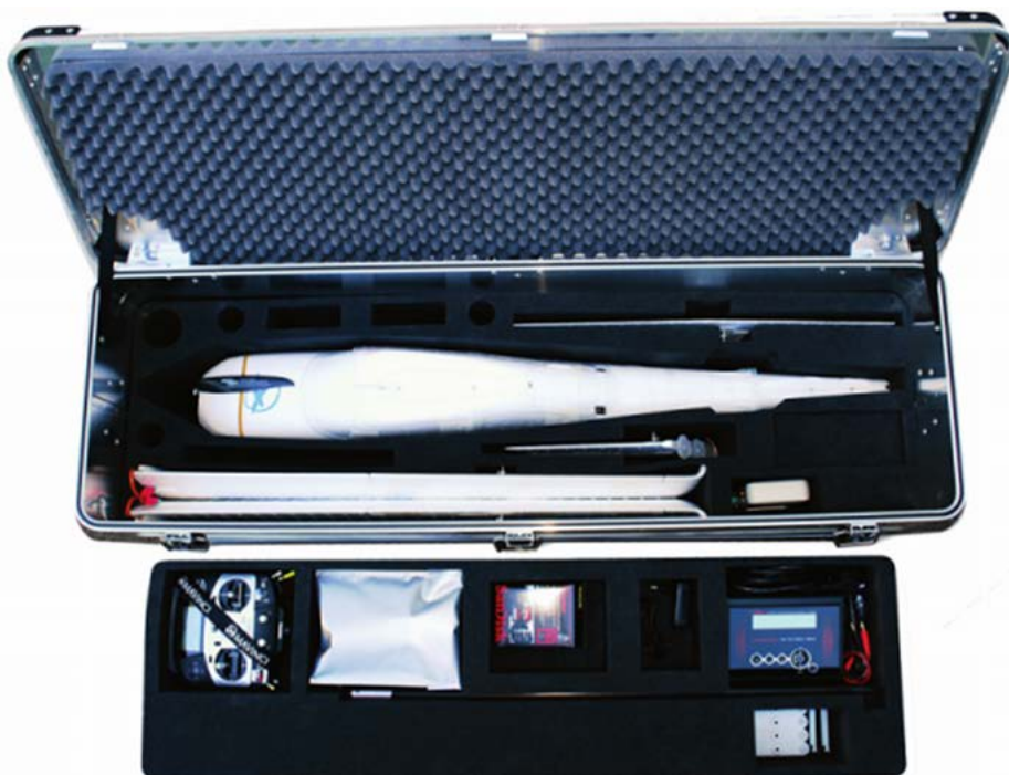
Obrázek 4.2 Bezpilotní letoun složený do přepravního boxu, který se vejde do každého osobního automobilu
