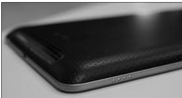
Obrázek 1.4 Dokovací konektor v podobě několika kontaktů
