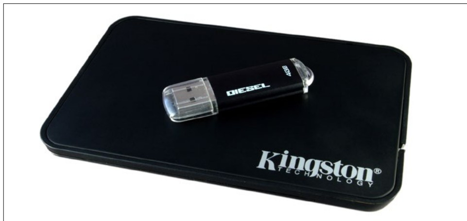
Obrázek 2.5: Dvě zařízení USB Mass Storage: flash disk a externí pevný disk
