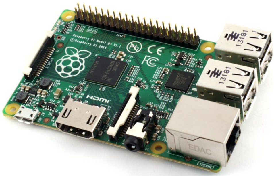
Obrázek 1.4: Základní deska modelu B+ počítače Raspberry Pi
